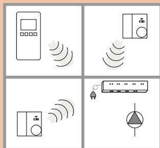
Uhrthermostat mit Analog-Einzelraumregler und mit 4-Kanal-Empfänger oder 6-Kanal-Empfänger Master – Slave Funktion und Heizungspumpe mit Pumpenlogik
