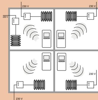
Uhrthermostat mit 1-Kanal-Empfänger
