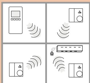
Uhrthermostat mit Analog-Einzelraumregler mit 4-Kanal-Empfänger oder 6-Kanal-Empfänger Master – Slave Funktion
